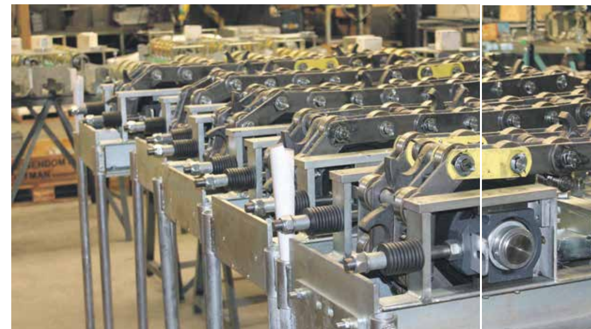
De assemblage van de Caterpillar-aandrijvingen in de montagehal in Tiel.
